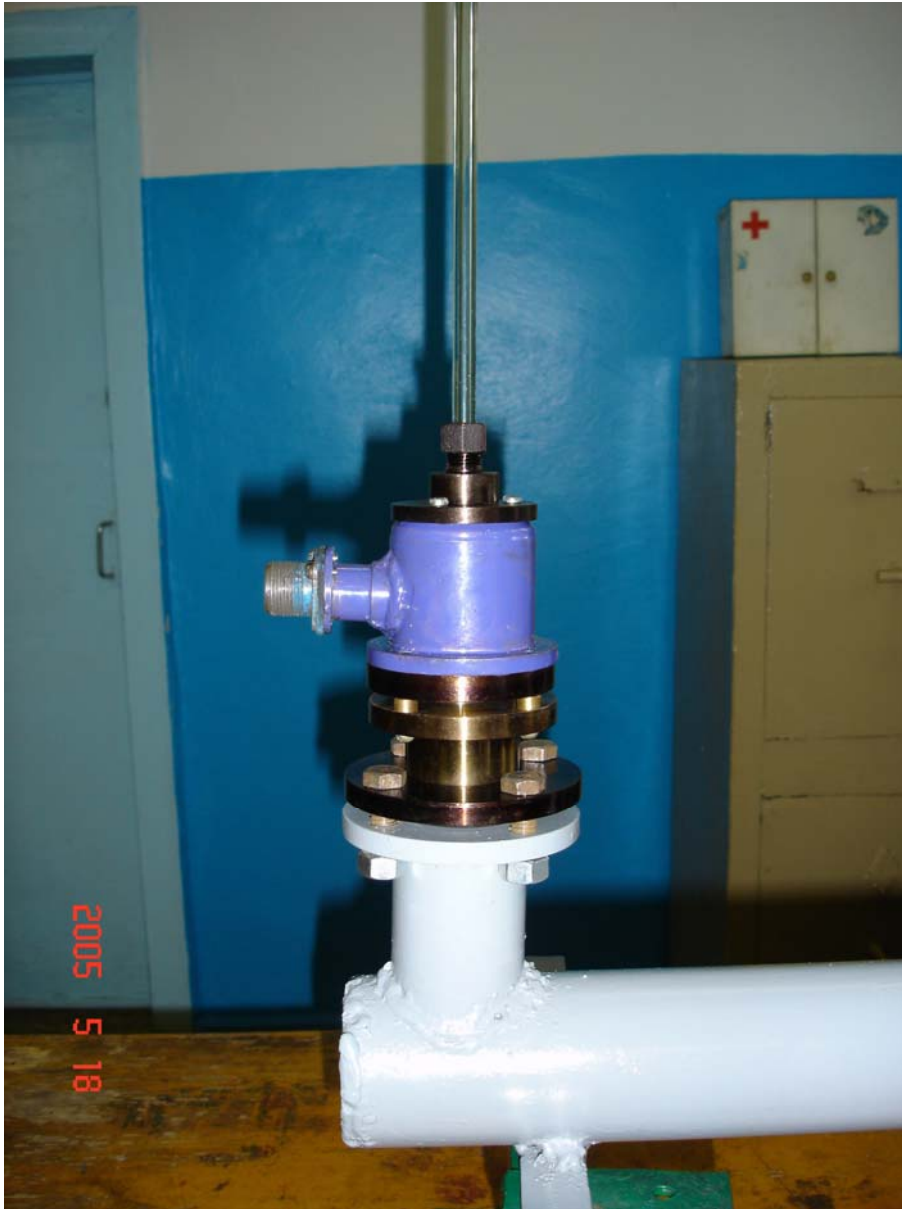
Рис. 3.8. Фотографія експериментальної моделі з визначення силової дії потоку на запірний елемент ЕПК
