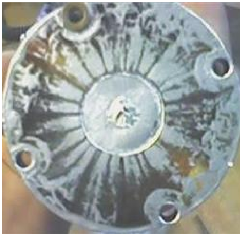
Рис. 3.12. Верхня кришка щілинного дифузора
