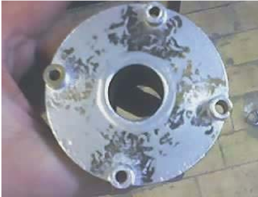
Рис. 3.13. Нижня кришка щілинного дифузора
